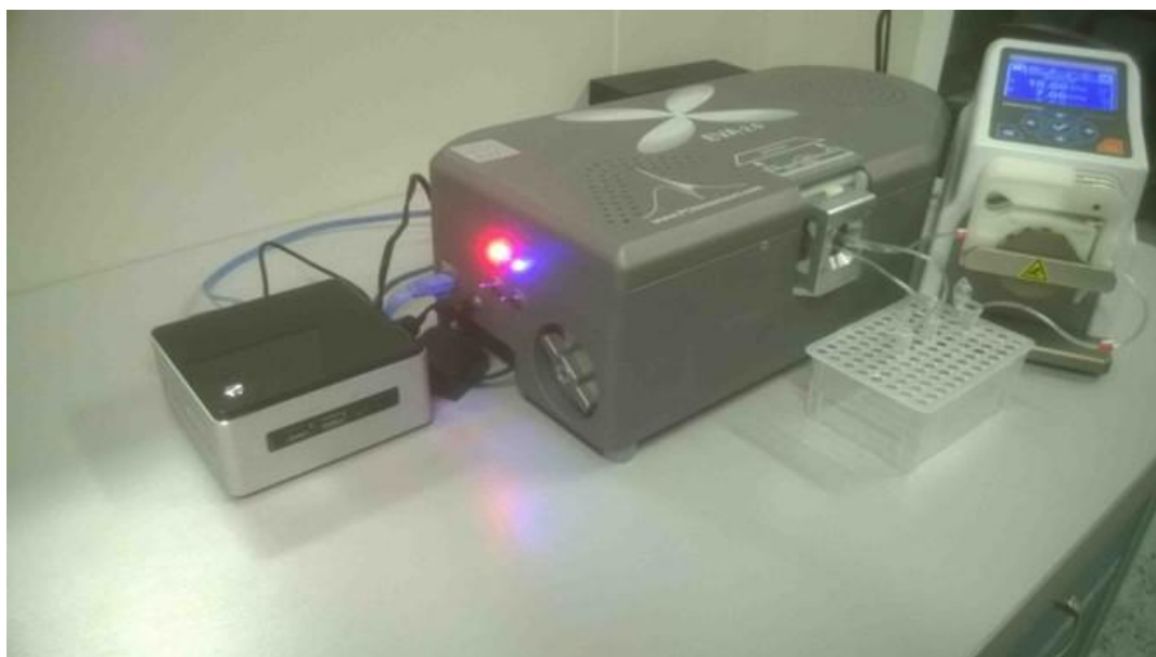
Рисунок 1. Биосенсор EVA 3.0 состоит из оптического блока, перистальтического насоса и компьютера.
